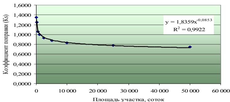
Наиболее точно (коэффициент корреляции 0,9922) эту зависимость описывает следующее уравнение:
